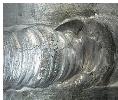
Фотография разветвленной трещины сварного шва, уходящая в глубину
