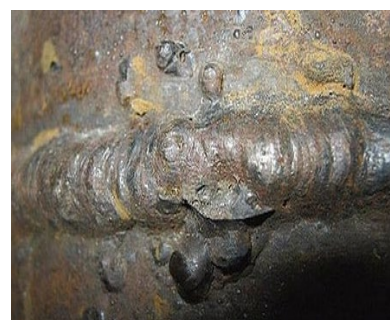
Фотография поры, заполненной газом полость круглой формы
