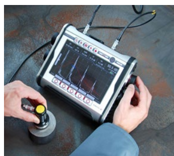
Фотография работы с электромагнитно-акустическим преобразователем
