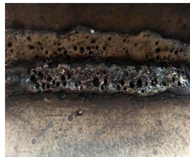
Фотография сварного шва с макро- и микродефектами
