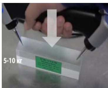
Калибровка прибора на контрольном образце из оргстекла
