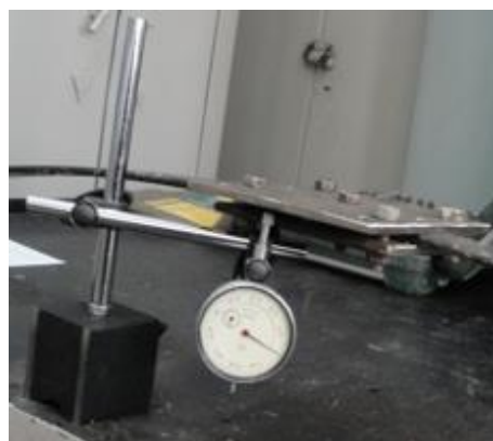
Рисунок 8. Измерение вертикальной деформации
