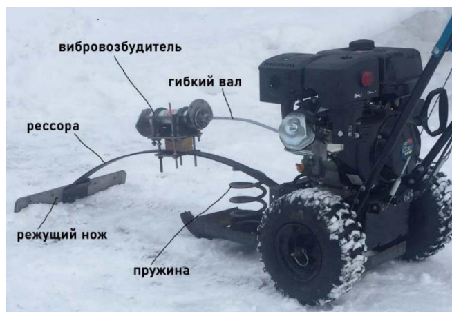
Рисунок 11. Опытный образец льдоскалывателя с упругим рабочим органом
