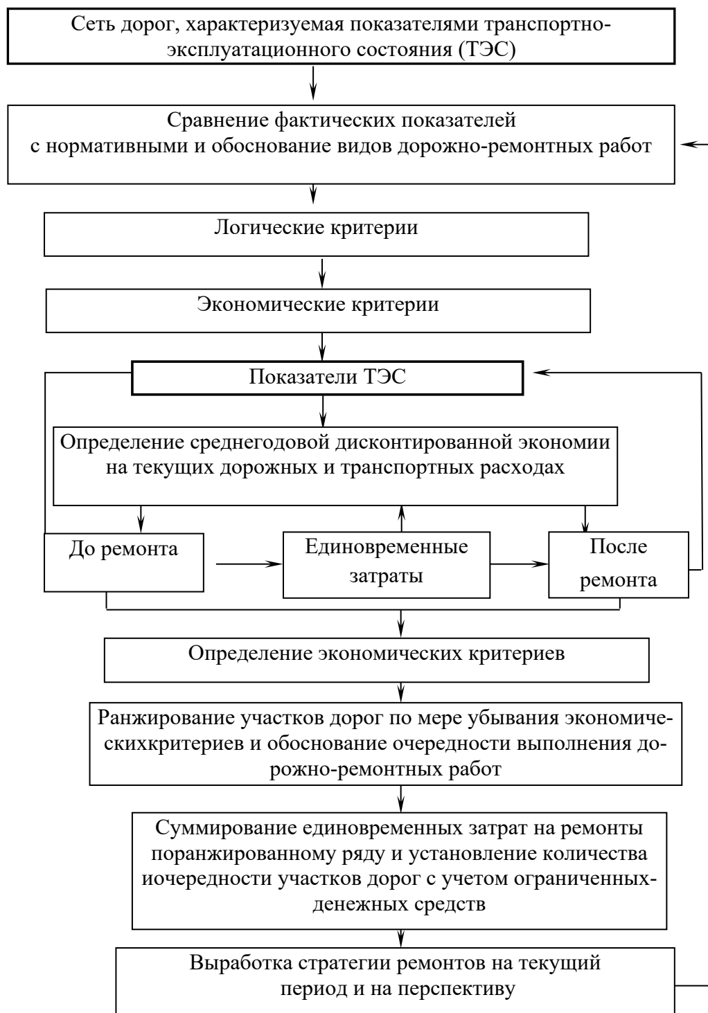
Рисунок 2. Структурная модель решения задачи по планированию дорожно-ремонтных работ при ограниченных ресурсах [материал автора]
