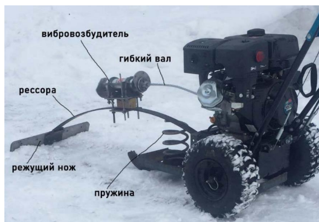
Рисунок 11. Опытный образец льдоскалывателя с упругим рабочим органом
