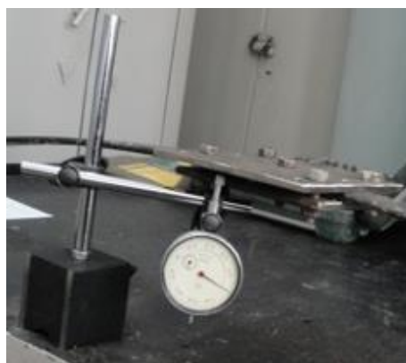
Рисунок 8. Измерение вертикальной деформации
