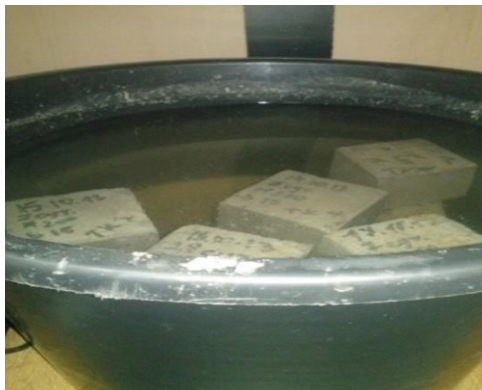
Рисунок 1. Определение концентрации растворов противогололедных реагентов [материал автора]
