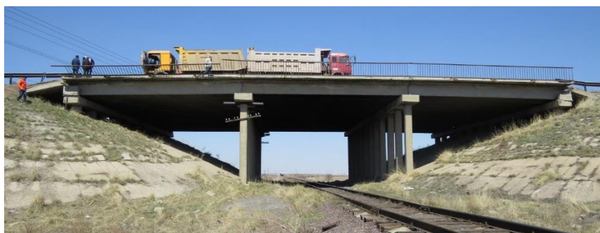
Рисунок 2. Статическое испытание промежуточной опоры №3
