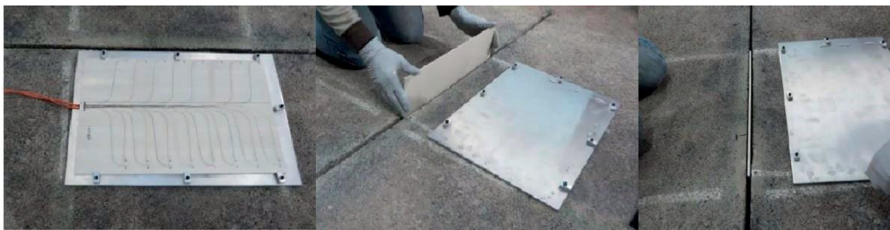
Сурет 2. Атлантик-Ситидегі, Нью-Джерсидегі, АҚШ-тағы Федералды авиация әкімшілігінің (FAA) (NAPTF) Ұлттық әуежайының сынақ полигонында бақылау тақтасын орнату [13]
