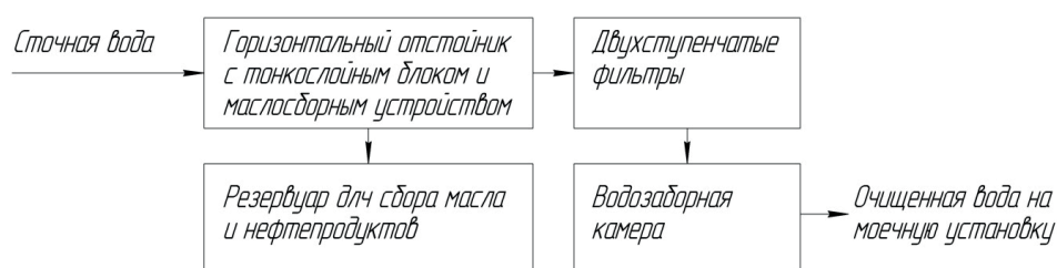
Рисунок 2. Схема очистных сооружений по типовому проекту Гипроавтотранса (ТП 902-2-416 86) [материал автора]
