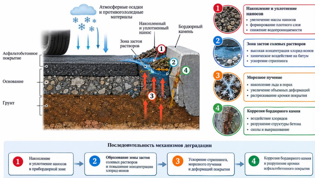
Рисунок 1. Схема механизмов деградации кромки асфальтобетонного покрытия при накоплении прибордюрного наноса [материал автора]
