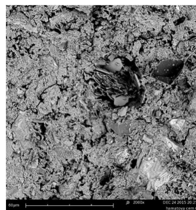
в) Микроструктура цементного камня ЦЕМ I 42,5Б в 2000-кратном увеличении
