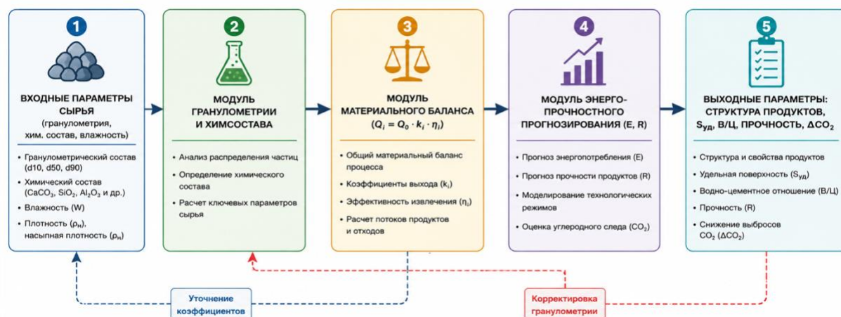
Рисунок 7. Структурная схема цифровой аналитической модели комплексной переработки известняковых отсеков [материал автора]
