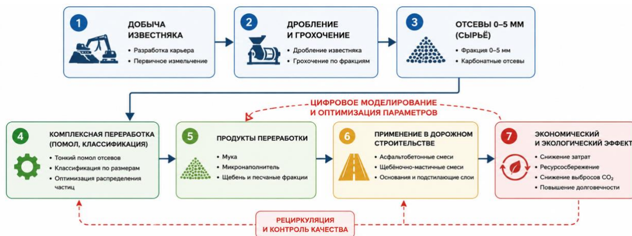
Рисунок 8. Концептуальная схема комплексного использования известняковых отсеvов в дорожном строительстве РК [материал автора]
