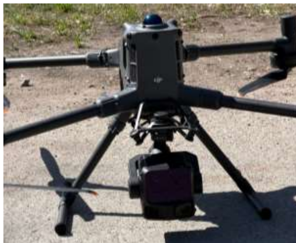
Рисунок 2. Подготовка беспилотного комплекса DJI Matrice 350 RTK к выполнению полевых работ [материал автора]
